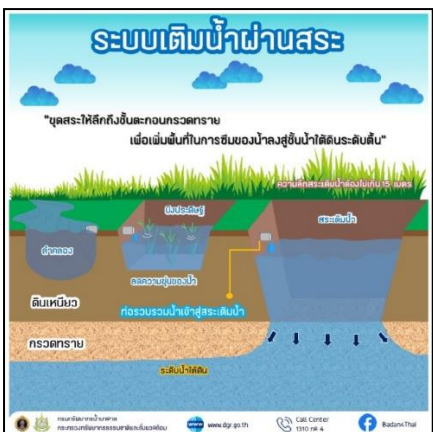
แบบมาตรฐานการก่อสร้างระบบเติมน้ำใต้ดินระดับตื้น (กรมทรัพยากรน้ำบาดาล, 2562)
