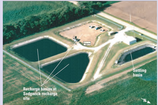
รูปที่ 16 โครงการและเติมน้ำบาดาลผ่านระบบสระเติมน้ำในสหรัฐอเมริกา (จาก USGS, 2005)
